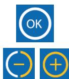
3. Нажмите OK, чтобы выбрать экранную страницу охлаждения. При помощи кнопок “+” и “–” выберите режим OFF (ВЫКЛ.) или охлаждения в течение от 10 до 360 минут.
