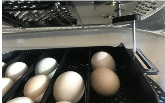
15. Вставьте стержень в паз вращающегося двигателя.
