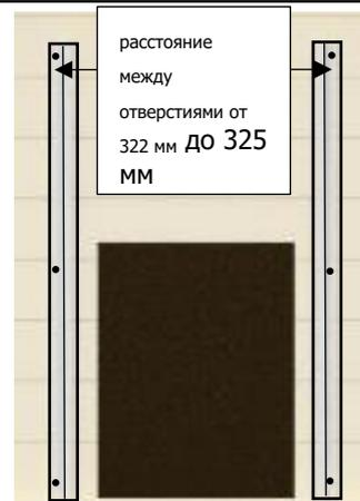
После того, как планки с продольными пазами будут установлены вертикально и расстояние между крепежными отверстиями будет составлять 322–325 мм, разметьте позиции для шести креплений. Просверлите отверстия диаметром 1,5 мм.
