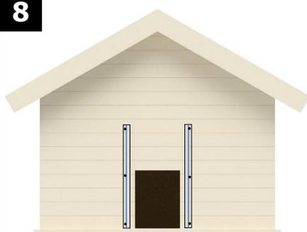
Расположите планки с продольными пазами на каждой стороне дверного проема птичника так, чтобы дверной проем располагался посередине между ними. Планки с продольными пазами должны быть расположены строго вертикально, ровно и в одной плоскости. Расстояние между крепежными отверстиями должно составлять 322-325 мм.
