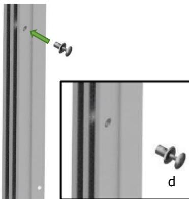
Вставьте пластиковую заклепку (d) в отверстие в каждой планке с пазами (как показано на рисунке).
