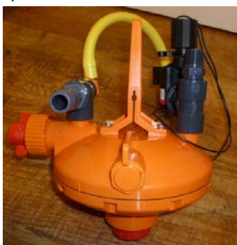
Рис. 2: Редуктор с магнитным вентилем
