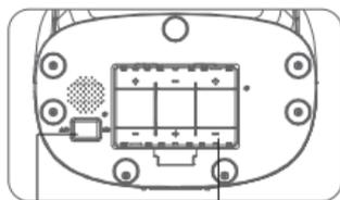
Выключатель Батарейный отсек
