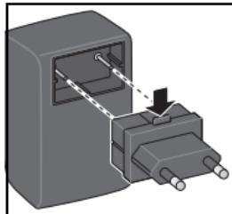
1. Tryck in uppläsningsknappen 8 när du drar bort den monterade stickproppsadaptern 9.
